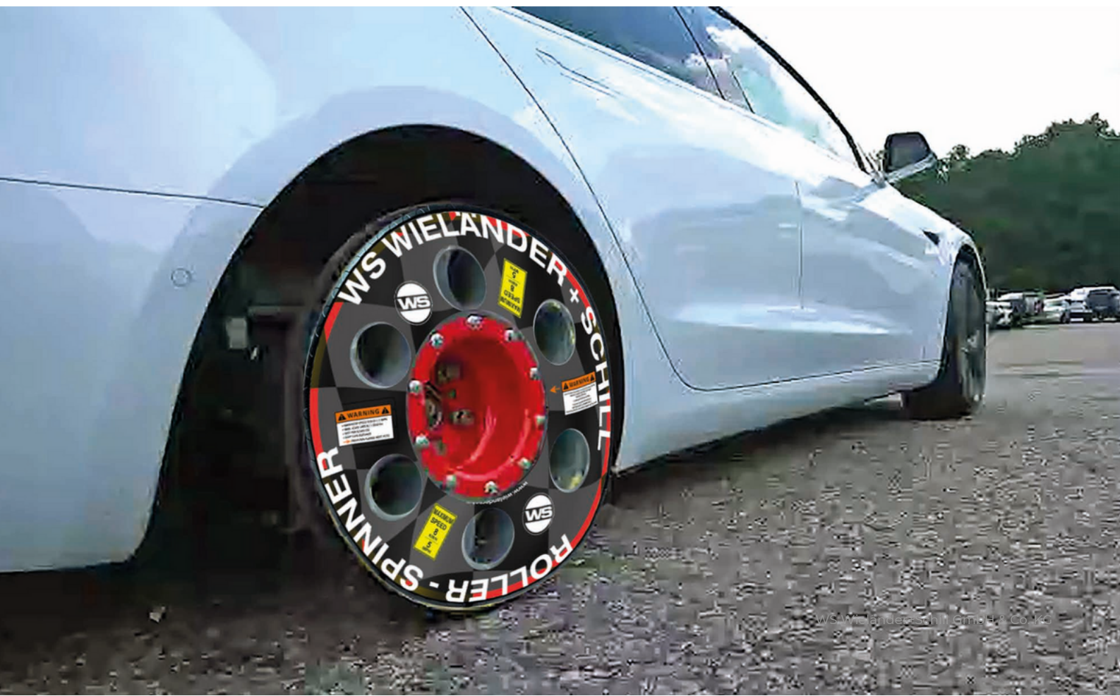
Tryb rolkowy Ze śrubami dokręcony wewnętrzny pierścień nie obraca się.
